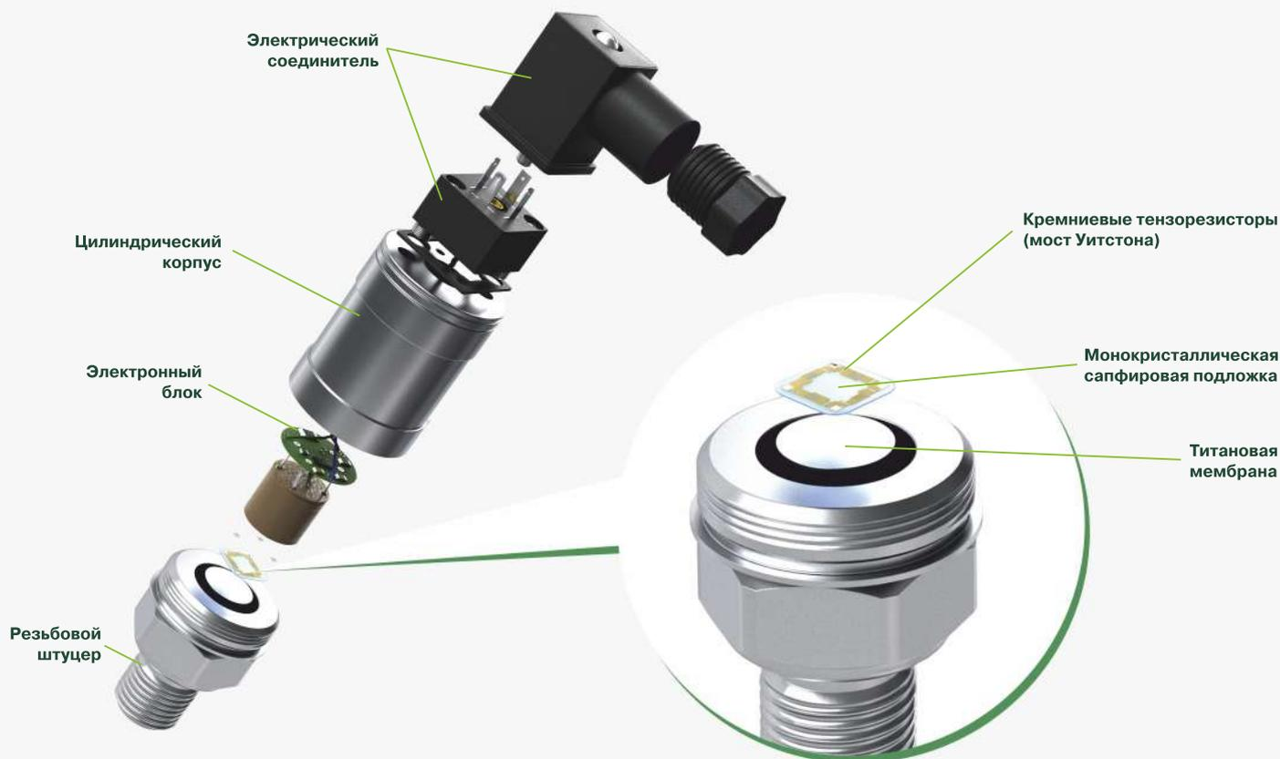
Конструктивно преобразователи представляют собой цилиндрический корпус с электрическим соединителем сверху для подсоединения к внешним электрическим цепям и резьбовым штуцером внизу для подачи измеряемого давления. Резьбовой штуцер выполнен из нержавеющей стали (РТМ) или из титанового сплава (РТМ-М). Внутри цилиндрического корпуса расположен чувствительный элемент и электронный блок.
