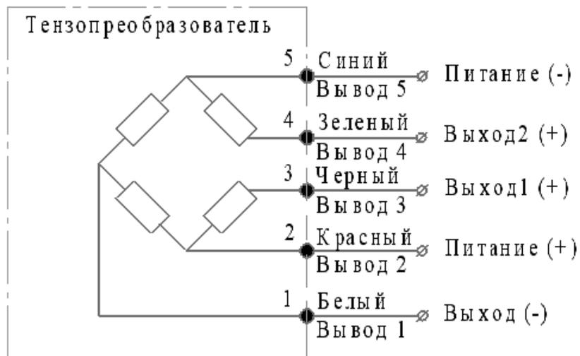
Рисунок А.2 – Схема «Разорванный мост»
